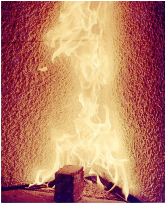
Probeta de poliuretano proyectado montada en el aparato de ensayo del SBI, para su clasificación al fuego en Euroclases.
