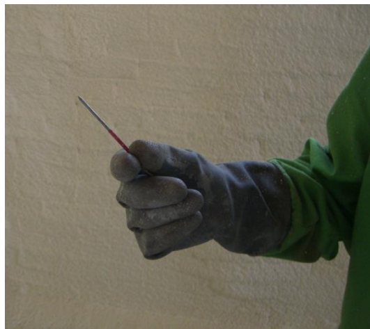
Punzón de no más de 2 mm de diámetro para realizar el ensayo de medición de espesor.
