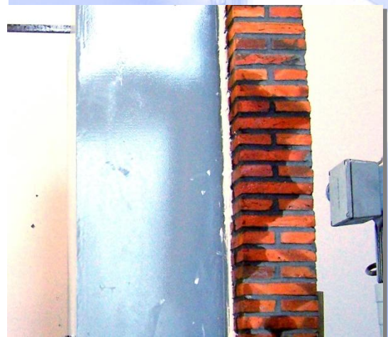
Vista lateral de la muestra tras el ensayo, donde se aprecia cómo el poliuretano se comportó como una barrera contra el agua, aún cuando ésta llegó a saturar el ladrillo y el mortero.
