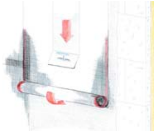
Figura 24. Detalle de la instalación de la malla de armadura sobre la fachada
