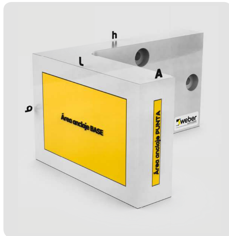
barandilla anclada en PUNTA
