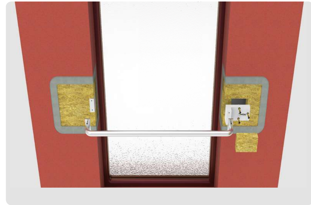
barandilla anclada en PUNTA
